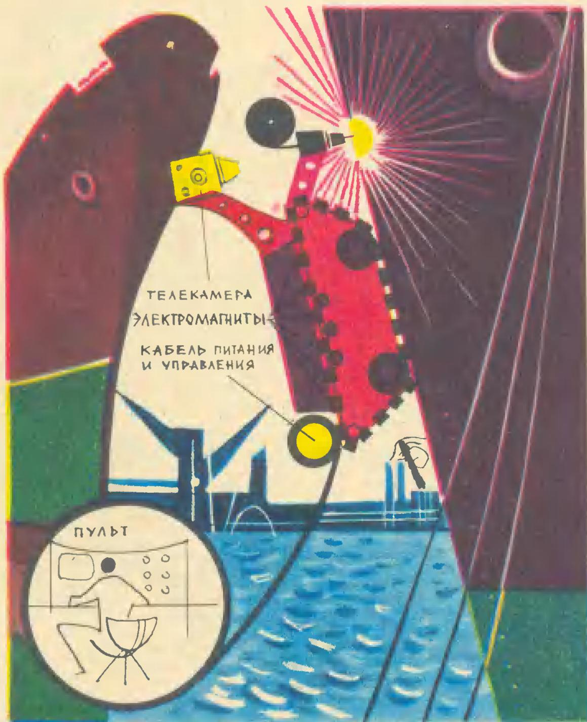
**МАГНИТОХОД.** Я предлагаю самоход, который не имеет какого-либо двигателя с вращающимися частями. Движение самохода осуществляется при помощи двух параллельных гусениц, на которые крепятся электромагниты. Располагаются они вдоль гусеницы на одинаковом расстоянии.
